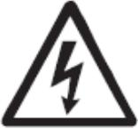
**Lebensgefahr** beim Öffnen des Gerätes, da spannungsführende Komponenten und Anschlüsse freigelegt werden. Vor dem Öffnen des Gerätes muss dieses **allpolig** vom Netz getrennt werden. Elektrische Arbeiten dürfen nur von dafür befähigten Personen vorgenommen werden (nach TRBS 1203).
