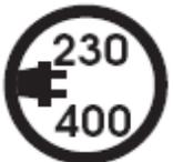
**Netzanschluss.** Die Spannung, die auf dem Typenschild des Gerätes angegeben ist, muss mit der Netzspannung übereinstimmen. Geräte mit Festanschluss müssen an eine dafür geeignete Trenn-Einrichtung (z.B. Hauptschalter) angeschlossen werden.
