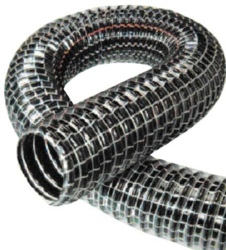
**Beschreibung:** **HERZ** – PVC-Spiralschläuche sind aus zwei Lagen PVC mit eingelegter Federstahlspirale hergestellt und zusätzlich mit axialer und radialer Fadenverstärkung(38/60/90mm) ausgerüstet. Zugfest, gute Öl-, Laugen- und Säurebeständigkeit, gute Chemikalienbeständigkeit, UV- und Ozonfest, Cadmiumfrei, innen weitgehendst glatt für eine gute Strömungscharakteristik, extrem flexibel und vakuumfest. Verlegung auf engstem Raum (kleine Biegeradien), abknicksicher und leicht.
