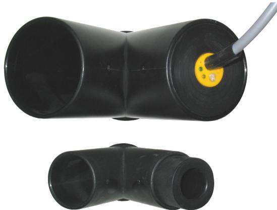
**Funktion:** Einteiliger Sensor zur Überwachung von Luftströmungen mit integrierter Auswerteelektronik. Das kalorimetrisch arbeitende Gerät ermöglicht mit seiner Teach-In-Funktion einen wartungsfreien Betrieb. Der werkseitig eingestellte Strömungsgrenzwert von 3 m/s ist in den Bereichen Gebäudetechnik und Maschinenbau bevorzugt, kann jedoch mit seinem TEACH-IN Taster der Aufgabenstellung angepasst werden.
